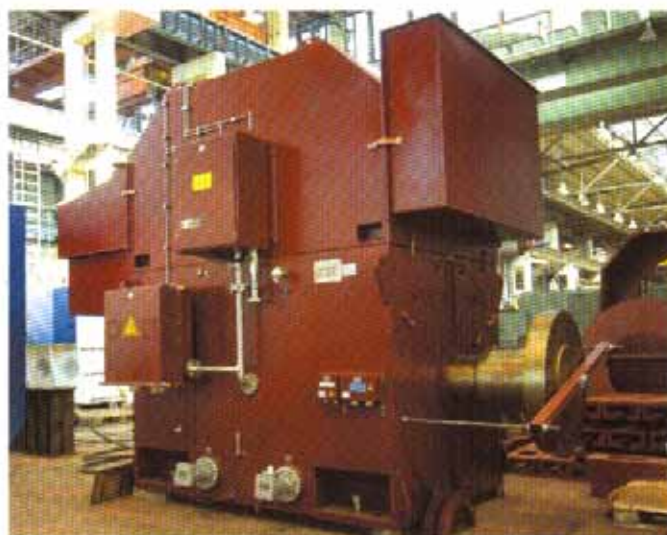
Асинхронный электродвигатель с короткозамкнутым ротором, привод компрессоров 2.852 кВт
