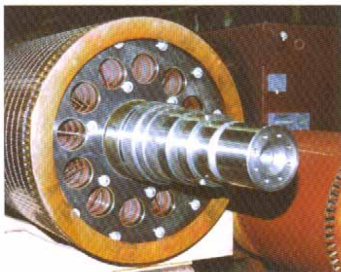
Короткозамкнутый ротор для асинхронного электродвигателя с радиальной вентиляцией
