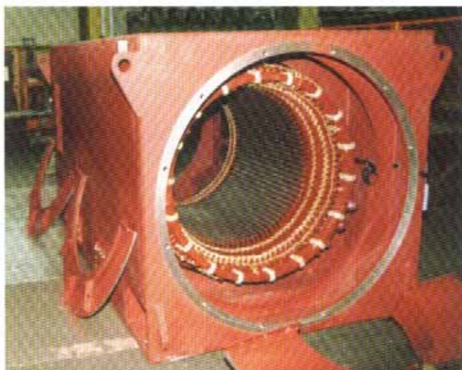
Сварной корпус во время монтажа
