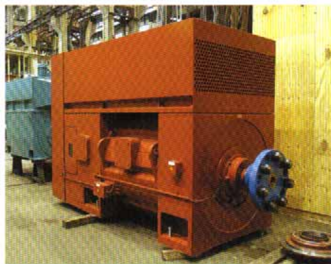
Асинхронная машина с охлаждением „воздух-воздух“ и фазным ротором
