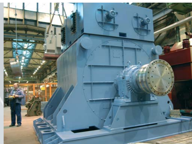
Привод для прокатного цеха Высоковольтный синхронный двигатель 5000 кВт, 2000 В, 0-160/400 min -1
