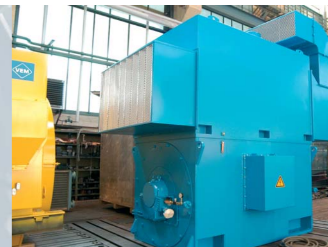
Привод экструдера Высоковольтные асинхронные двигатели с короткозамкнутым ротором 4000 кВт, 11000 В, 1186 min -1
