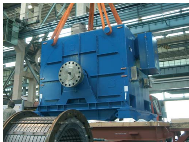
Привод поршневого компрессора Высоковольтные синхронные двигатели Ex p II BT3 7600 кВт, 10000 В, 360 min -1
