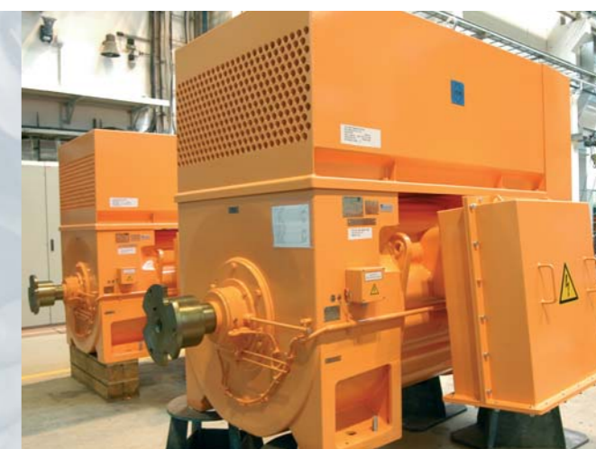
Привод насоса для суспензий Высоковольтный асинхронный двигатель с короткозамкнутым ротором 800 кВт, 11000 В, 994 min -1
