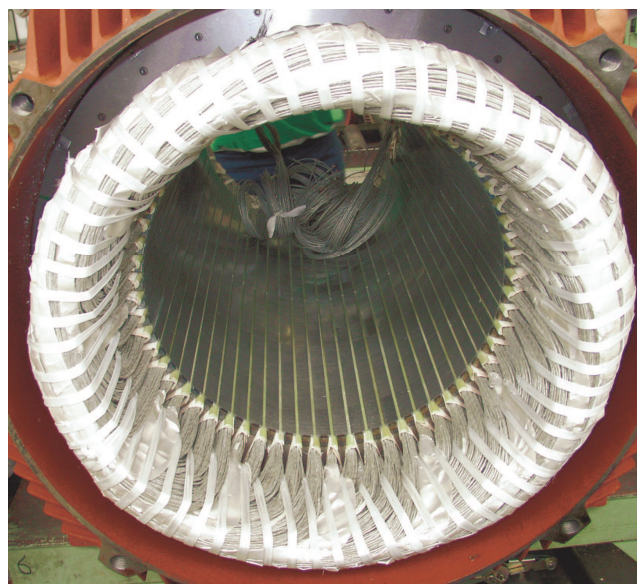
Типоразмер KV.R, обмотанный, непропитанный пакет статора
