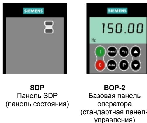
Рис. 3-3 Панели индикации/управления для преобразователя MICROMASTER 430
